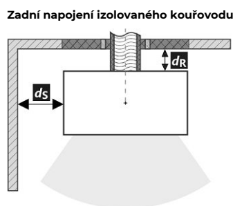
Prostup kouřovodu stěnou z hořlavé hmoty ČSN 06 1008
